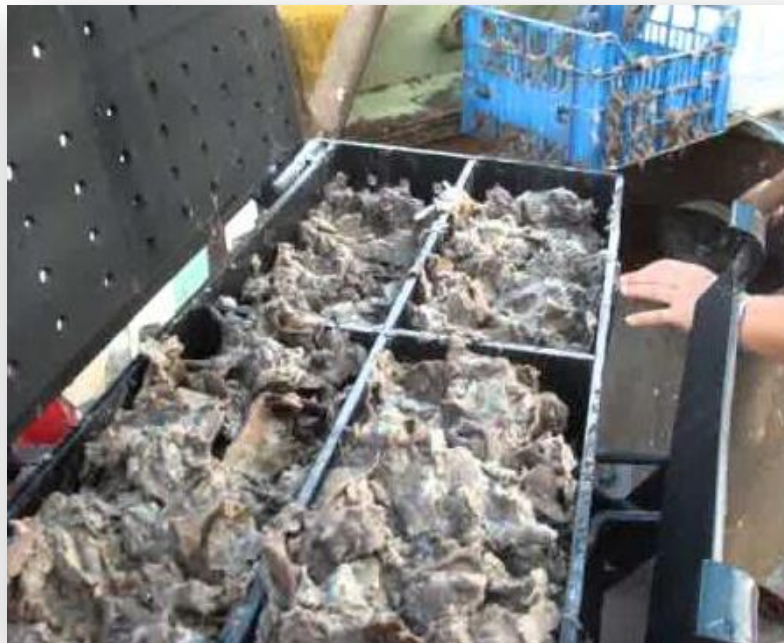
2. A papírtégla gyártó gépbe helyezik a papírhulladékot, ami téglákat formál belőle
